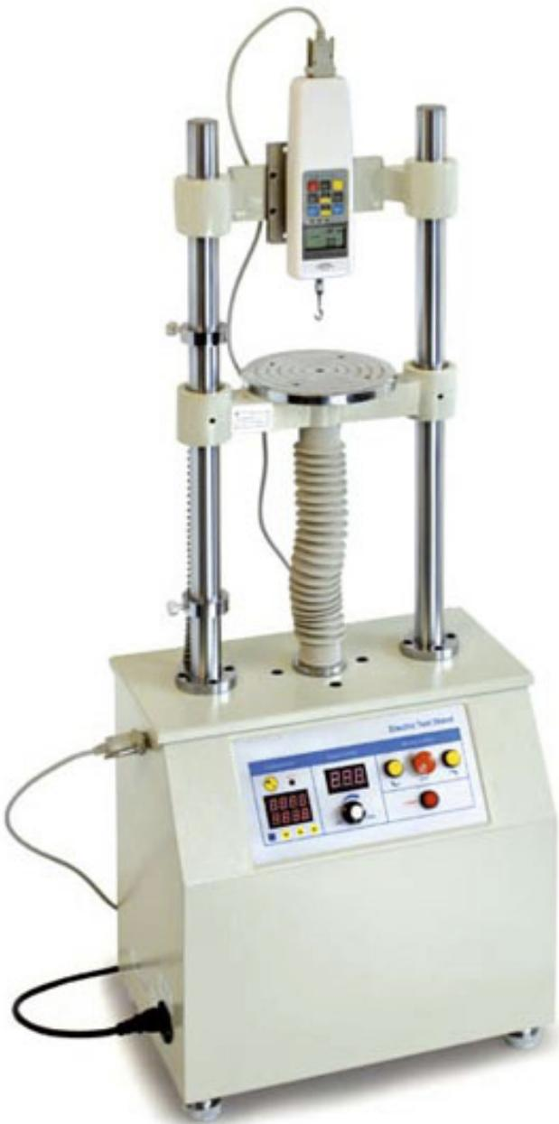
Motorisierter vertikaler Prüfstand TVM-N
